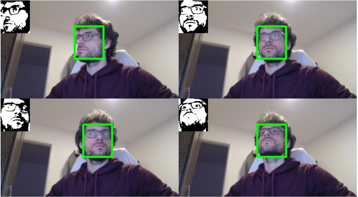
Figura 6.3: Rastreamento através de modelo - Rosto
